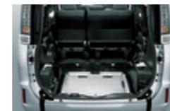
スロープ前倒し機構(前倒し時)
