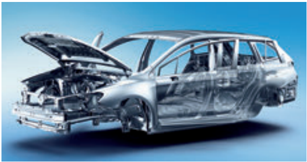
走りに重要な部位と各構造部材を強化した高剛性ボディ
