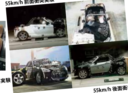
55km/h 前面衝突実験 64km/h オフセット衝突実験
