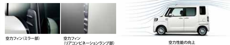
空力フィン(ミラー部) 空力フィン(リアコンビネーションランプ部) 空力性能の向上
