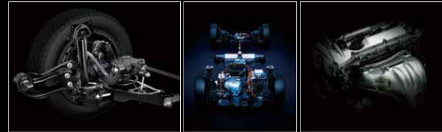
ダブルウィッシュボーンリアサスペンション、ハイブリッドシステム、2.5L 2AR-FE Dual VVT-i エンジン
