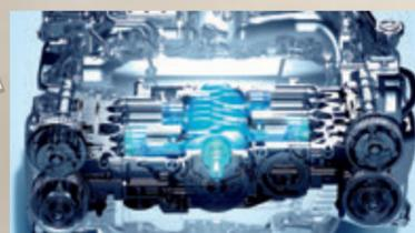
左右のピストンが水平方向に往復する様子が、まるでボクサーが互いにパンチを繰り出しているように見えることから「BOXER」と呼ばれる水平対向エンジン
