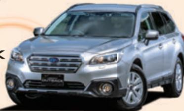
ワゴンとSUVのメリットを融合させたLサイズモデル。最低地上高は200mmと余裕があり、シメトリカルAWDとの相乗効果で、悪路の走破力も優れている。エンジンは水平対向4気筒の2.5リッターを搭載。低回転域から高い駆動力を発揮して、スポーティな走りも満喫できる。アイサイトバージョン3を筆頭に安全装備も充実させた。
