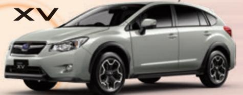
ミドルサイズのハッチバックとSUVを融合させたモデル。最低地上高は200mmを確保したので、悪路のデコボコも乗り越えやすい。シメトリカルAWDとの相乗効果で、優れた走破力を得られる。その一方で全高は1550mmに抑えられ、立体駐車場を使える貴重なSUVとなった。アイサイトバージョン3により、安全性と快適性も高い。
