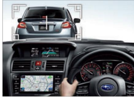
カラー画像化によって、先行車のブレーキランプの点灯も認識する
