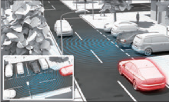
リアトラフィックアラート(後退時警告・衝突軽減ブレーキ機能)
