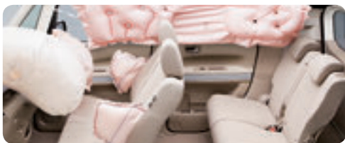
前席用1サイドエアバッグシステム+サイドカーテンエアバッグシステム
