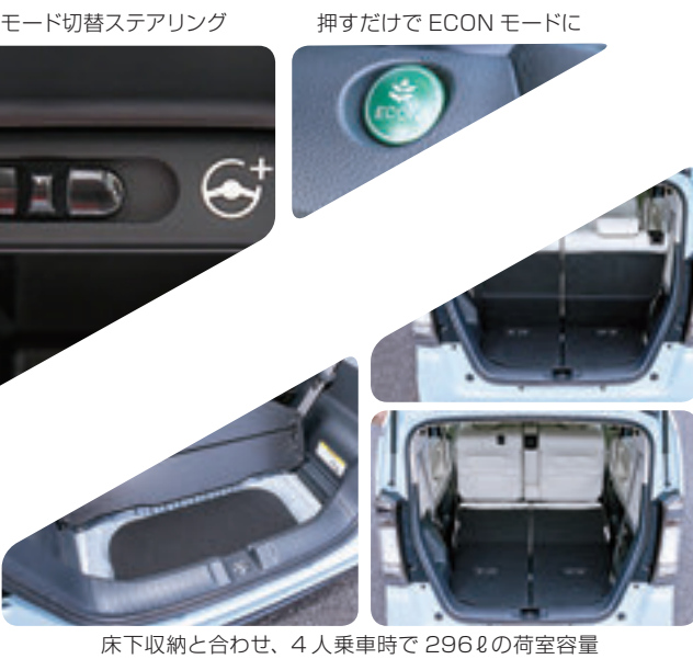
床下収納と合わせ、4人乗車時で 296ℓの荷室容量
