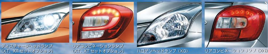
ディスタンスヘッドランプ (XT, XTセットオプション)   リアコンビネーションランプ (XT, XTセットオプション)   ハロゲンヘッドランプ (XG)   リアコンビネーションランプ (XG)
