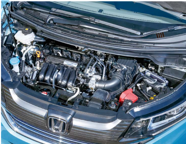
1.5 ℓ アトキンソンサイクルDOHC i-VTECエンジン+モーター内蔵7速DCT
