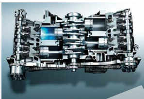
小排気量のエンジンに直噴ターボを組み合わせた1.6ℓインテリジェント「DIT」
